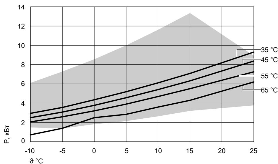
Потребляемая электрическая мощность при температурах подачи вторичного контура 35 °C, 45 °C, 55 °C, 65 °C
