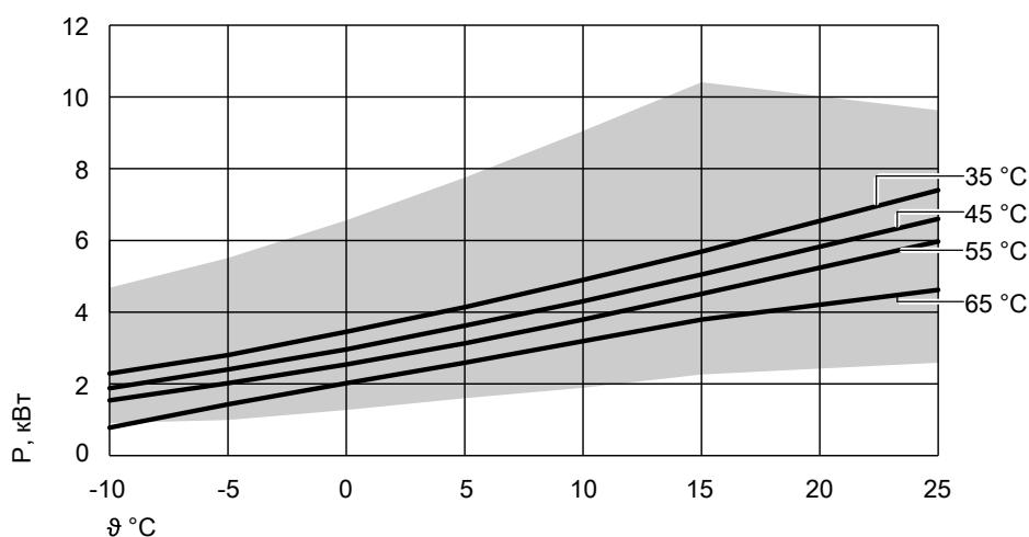
Потребляемая электрическая мощность при температурах подачи вторичного контура 35 °C, 45 °C, 55 °C, 65 °C
